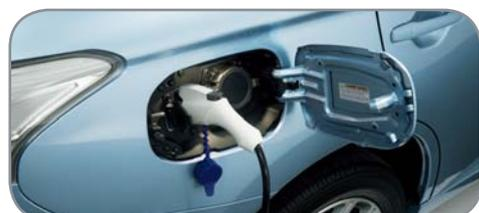
La ricarica completa in sosta (quindi non utilizzando il propulsore a benzina) si effettua in circa cinque ore\* da una semplice presa domestica. In alternativa, puoi utilizzare il sistema di ricarica rapida (80% della capacità della batteria in 30 minuti), anche presso le stazioni di ricarica commerciali. Il livello di carica viene comodamente visualizzato sul quadro strumenti.
